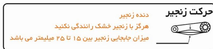
برای تنظیم زنجیر به روش زیر عمل نمایید:
