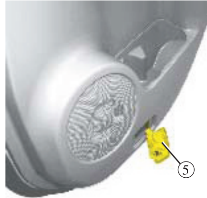
چراغ های در ۵ با استفاده از پیچ گوشتی دو سو چراغ شماره ۵ را باز کنید. روکش شفاف را باز کرده و سپس لامپ را تعویض کنید. نوع لامپ : W5W
